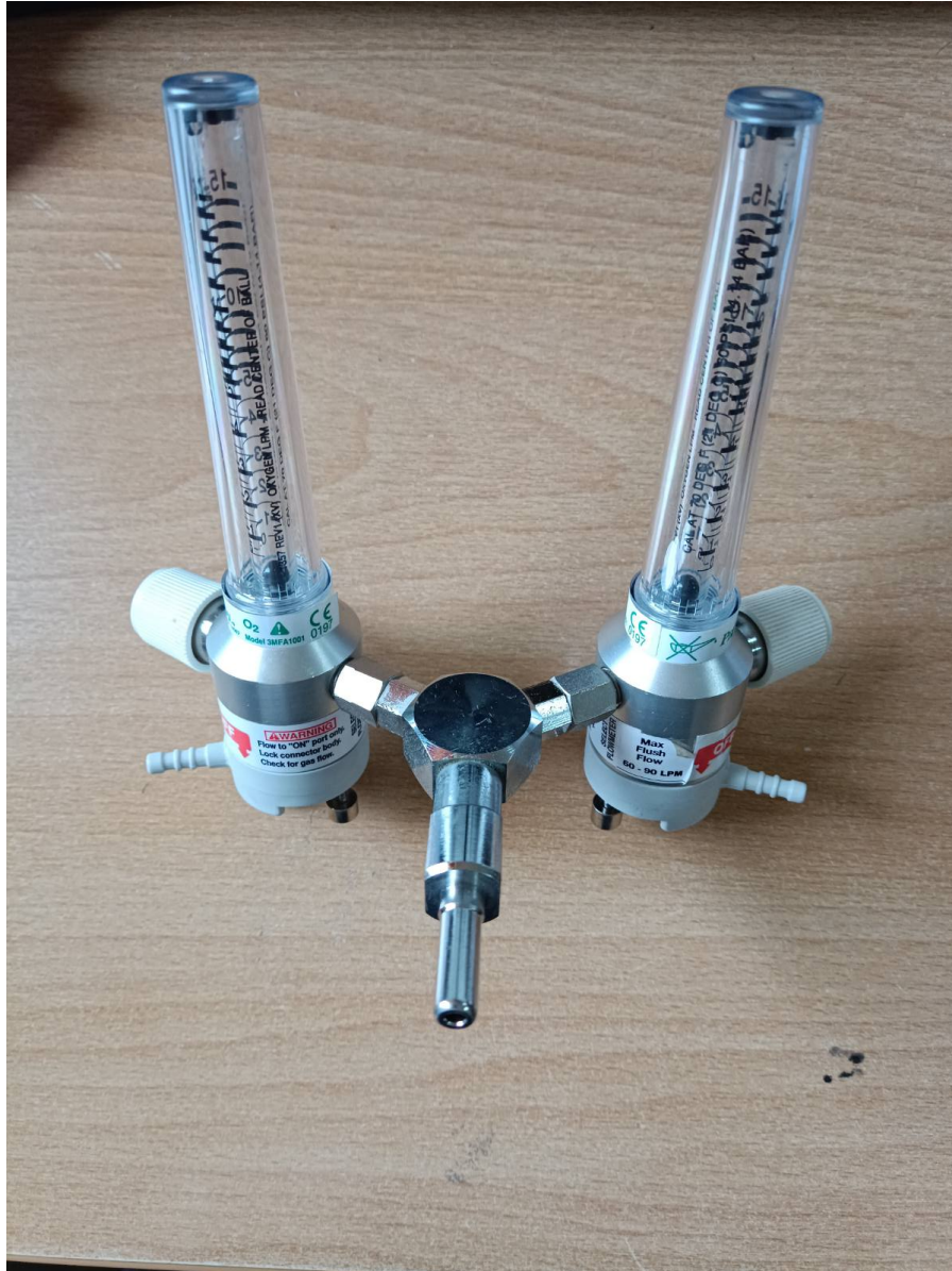
φωτογραφία 2. (ροόμετρο με επιλογή και υγρανήρα )
